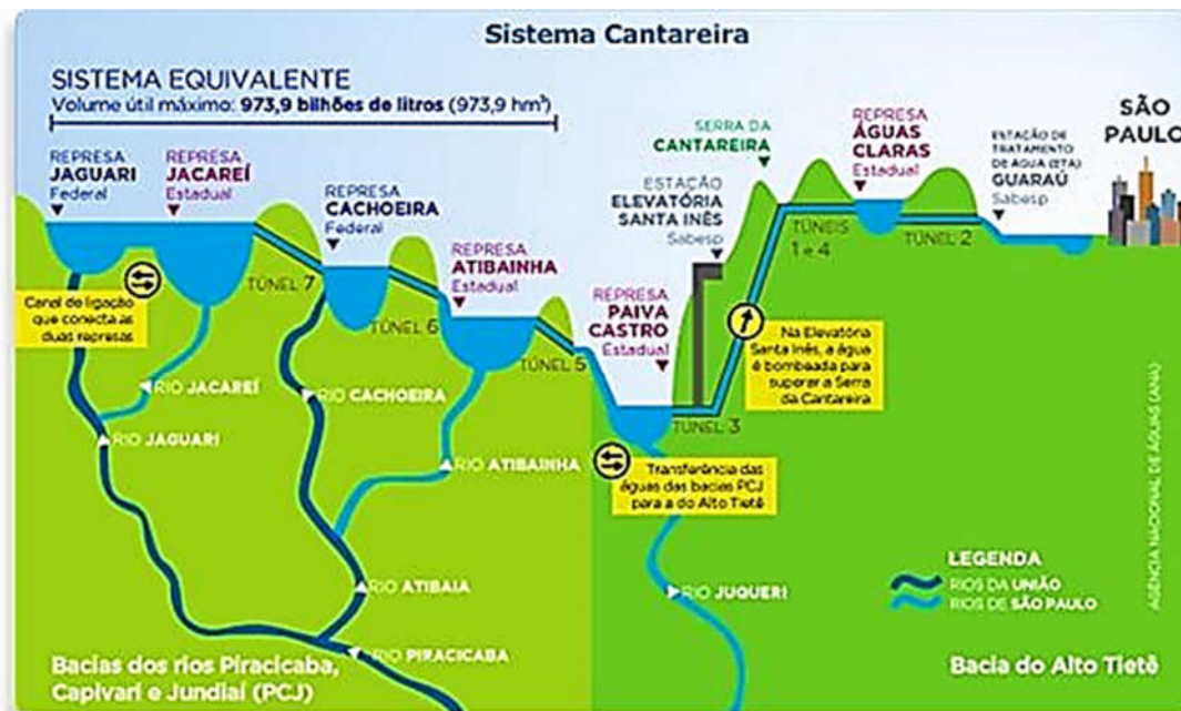
Figura 44 - Esquema Sistema Cantareira de Captação de Água
